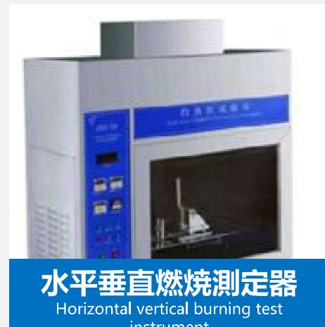
**水平垂直燃焼測定器**
